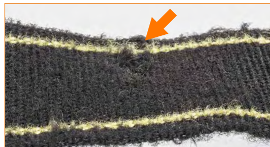
Riemen mit Abnutzung und offensichtlichem Austreten von Fäden.
