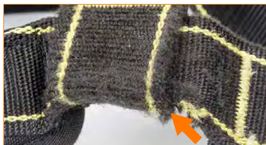
Cinta extremadamente desgastada en el punto donde cruza otra cintas.
