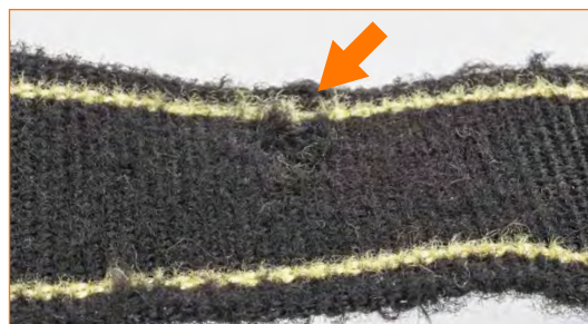
Fettuccia usurata con evidente fuoriuscita di fili.
