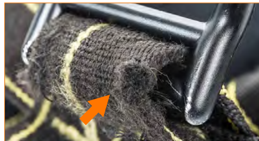
Riemen mit extremer Abnutzung in der Nähe des ventralen Rings.
