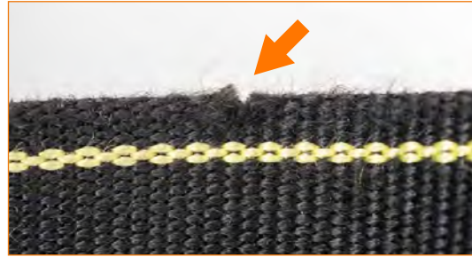
Riemen mit leichtem Einschnitt außen.
