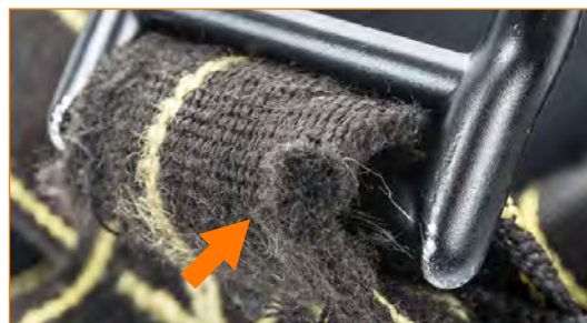
Fettuccia estremamente usurata in prossimità dell'anello ventrale.
